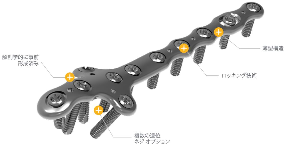
ロックングとノンロックング ネジにより、外科医は 3.0 または 3.5 mm ヘックスローブと 4.0 mm 海綿ネジからの選択が可能になっています。これらのヘックスローブ ネジと一緒に使用するための関連するドリル、ロックングドリル、ドライバーは手術手技にリストされています。
